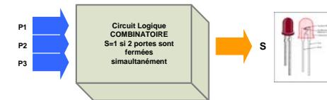
Nous avons installé dans un bâtiment (voir le schéma de la pièce), un circuit qui détecte quand 2 portes sont fermées simultanément. En effet il doit toujours y avoir une circulation d'air dans cette pièce. Quand 2 portes sont fermées alors la sortie S doit passer à 1 et allume par la même une LED de visualisation.
